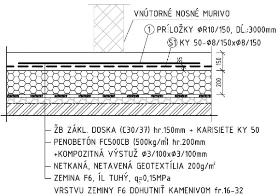
REZ ZÁKLADOVOU KONŠTRUKCIOU VNÚTORNÁ NOSNÁ STENA
