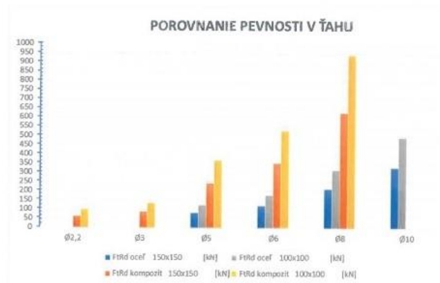
Graf.1 Porovnanie pevnosti v ťahu pri ploche zodpovedajúcej KARI SIETI s výstužou po 150mm a 100mm
